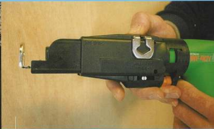
De neusjes van de Hitachi moet je aan de schroeflengte aanpassen.
